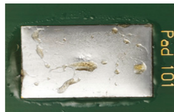
Flussmittelrückstände μ-Wire SN100C B2012
